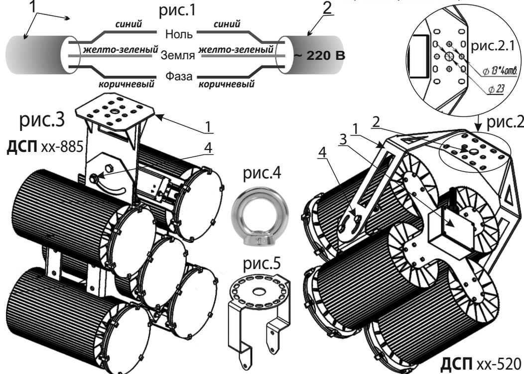
**в)** Для монтажа и подключения светильника ДСП хх-520, хх-885 (рис.2,3) к эл.сети необходимо:
