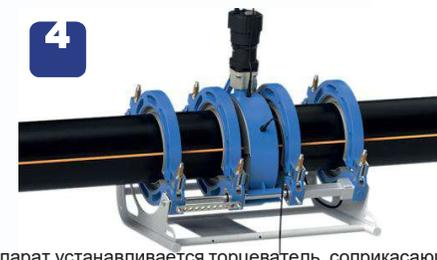
В аппарат устанавливается торцеватель, соприкасающиеся поверхности труб обрабатываются, торцеватель убирается и производится регулировка смещения кромок труб (норма – меньше 10% толщины стенки). После регулировки смещения при необходимости производится дополнительное торцевание.
