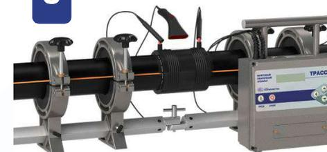
Параметры сварки вводятся в аппарат с помощью сканера штрих-кодов или вручную. Производится сварка.
