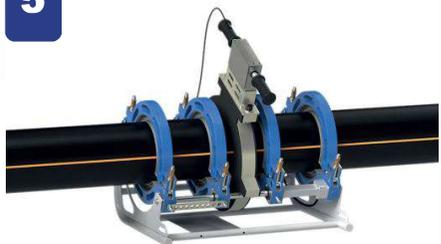
Устанавливается нагреватель, трубы сводятся и оплавляются, нагреватель удаляется.
