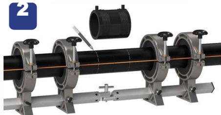
Трубы устанавливаются встык. Трубы фиксируются с помощью позиционера. Ставится метка. Муфта надевается на трубу и сдвигается в край.
