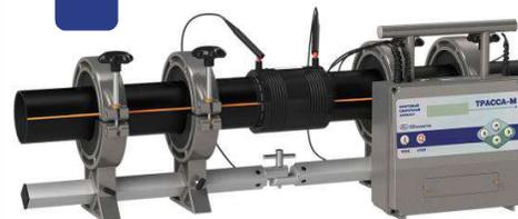
Срезается град. Муфта устанавливается согласно меткам. Подключается сварочный аппарат.
